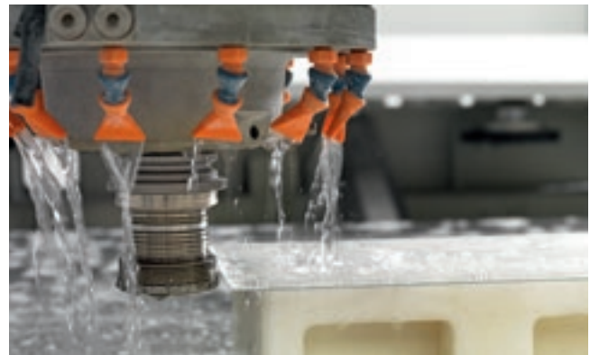
Schleifen von ultradünnem Glas.
