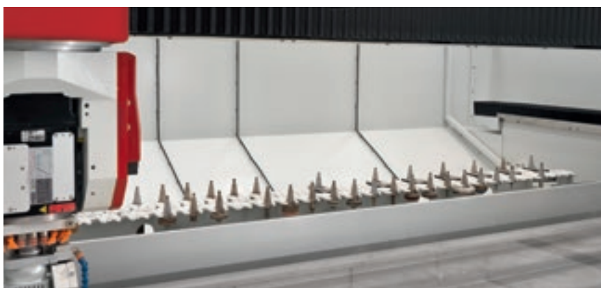
Hinteres Magazin mit Doppelreihe.
