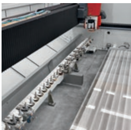
Hinteres Magazin mit Einzelreihe.
