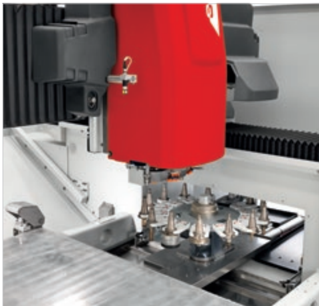
Rotierendes Werkzeugmagazin, das auch während des Maschinenbetriebs völlig sicher mit Werkzeugen beschickt werden kann.
