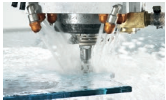
Bohren von oben.
